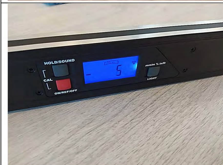
Фото №14. Измерения уровня напольного покрытия в прихожей.
