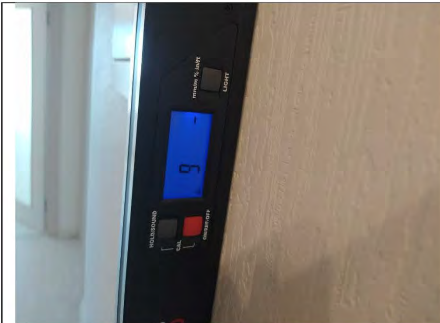
Фото №10. Измерения уровня стен в прихожей.
